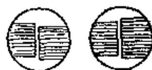
图 4-12 左右铁心的偏移
