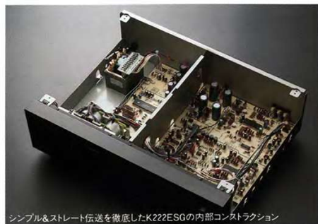
シンプル&ストレート伝送を徹底したK222ESGの内部コンストラクション
