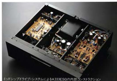
ミッドシップドライブ・システムによるK333ESGの内部コンストラクション
