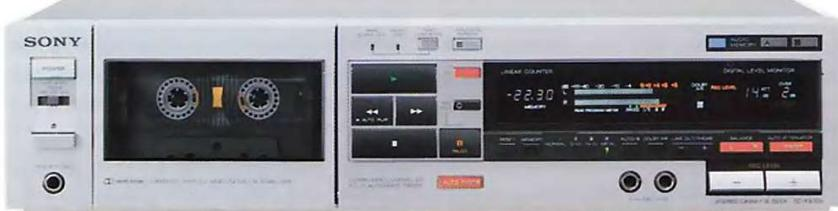
主な仕様 ●ヘッド: 消去1、録再1 ●モーター: DCサーボモーター1、DCモーター1 ●SN比: ≈56dB、59dB(ドルビーOFF、ピークレベル、METALLICカセット)、72dB(ドルビーNR-Cタイプ) ●周波数特性: ≈30~17,000Hz±3dB(METALLICカセット) ●周波数範囲: ≈20~19,000Hz(METALLICカセット) ●ワウ・フランジャー: ≈±0.06%W Peak、0.04%WRMS ●ひずみ率: ≈0.5%(METALLICカセット) ●大きさ: 430(幅)×105(高さ)×275(奥行)mm ●重さ: 6.2kg ●消費電力: 26W
